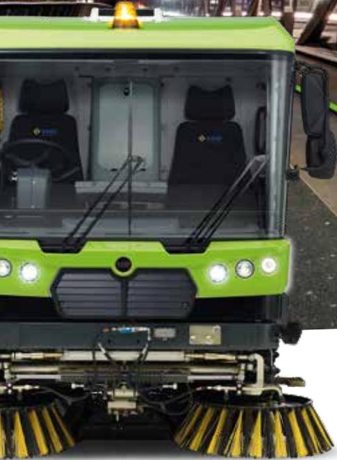
La RAVO 5 eSeries est une balayeuse compacte et conviviale qui répond à des exigences très strictes. La balayeuse a une capacité de trémie allant jusqu'à 5 m<sup>3</sup>, un taux de compactage exceptionnellement élevé et combine une durée de vie extrêmement longue avec de faibles coûts d'exploitation. Grâce au système de suspension hydropneumatique et au contrôle de niveau automatique, le travail avec la machine est confortable, précis et propre.
