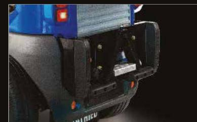
Prédisposition mécanique, hydraulique et électrique arrière pour saleuse avec commandes depuis la cabine
