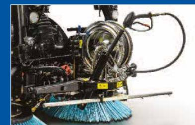
• **Un kit de lavage**, muni d'une pompe haute pression, d'une rampe de lavage frontale amovible équipée de deux jets latéraux et d'une lance couplée à un enrouleur automatique, sera indispensable pour vos opérations de lavage.
