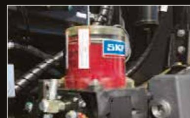
Graissage centralisé automatique
