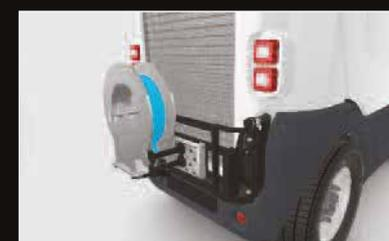
Enrouleur automatique de 15 m fixé à l'arrière sur châssis articulé
