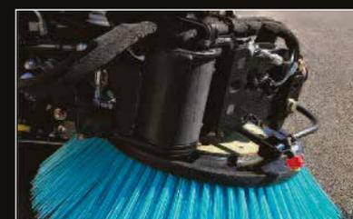
Réglage hydraulique depuis la cabine de l'inclinaison des balais
