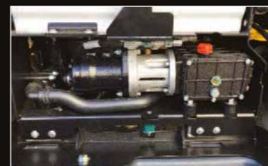
Pompe haute pression 150 bars @ 20 l/min avec lance haute pression et 5 m de tuyau
