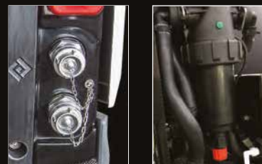
Filtre à eau au remplissage + coupleur à eau Storz DN 25
