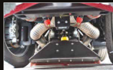
Vorbereitung am Saugschacht zum ansaugen von Schmutzwasser bei Verwendung des 3-Bürsten-Schrubbdecks
