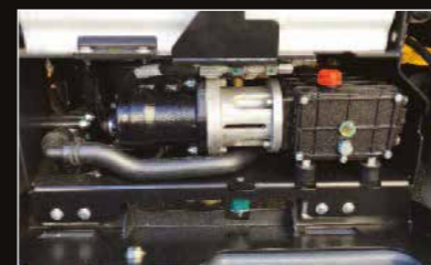
Hochdruckpumpe 150 bar bei 20 l / min mit Hochdruckkanne und 5 m Schlauch
