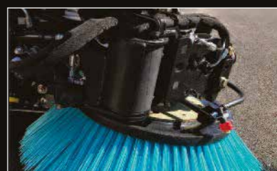
Hydraulische Neigungsverstellung der Seitenbesen über dem Joystick
