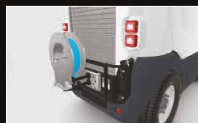
Automatische Schlauchtrommel mit 15m HD Wasserschlauch, an der Rückseite, auf klappbaren Rahmen angebracht
