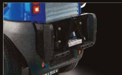
Kuppeldreieck mit hydraulische und elek- trische Anschlüsse zur Aufnahme eines Salzstreuers
