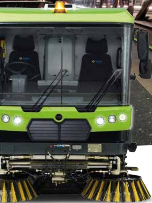
Die RAVO 5 eSerie ist eine benutzerfreundliche, kompakte Kehrmaschine für höchste Ansprüche. Das Fassungsvermögen des Behälters beträgt 5 m<sup>3</sup>. Er bietet ein besonders hohes Kompressionsverhältnis und äußerst lange Lebensdauer bei geringen Betriebskosten. Durch das hydropneumatische Aufhängungssystem und die automatische Bodenabstandseinstellung gestaltet sich die Arbeit mit dieser Maschine komfortabel, präzise und sauber.
