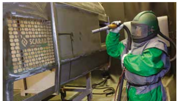
Kehrgutbehälter aus Edelstahl wird sandgestrahlt
