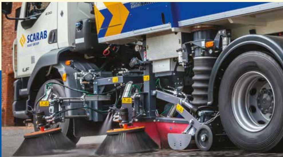
La Magnum 72 n'est que l'une des nombreuses solutions de balayage des routes montées sur camion élaborées par l'expertise Scarab. En raison de cette flexibilité, la Magnum 72 peut être installée sur un large choix de châssis, notamment ceux de DAF, Iveco, MAN, Mercedes, Volvo, Renault, Freightliner et bien d'autres. Pour plus d'informations sur les spécifications de châssis compatibles, veuillez contacter votre distributeur local.
