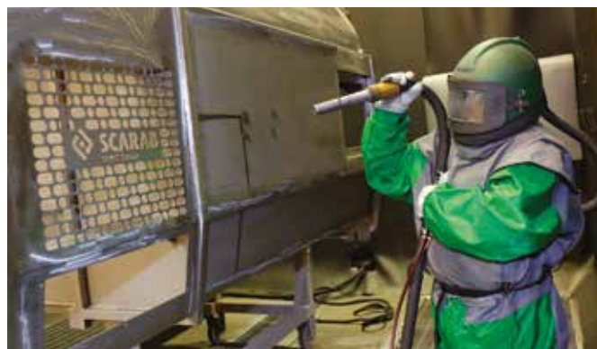
Kehrgutbehälter aus Edelstahl wird sandgestrahlt
