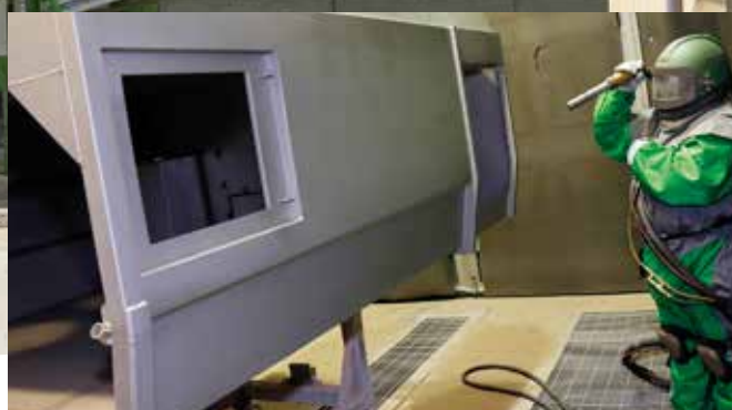
Grenailage du corps en acier inoxydable de la trémie
